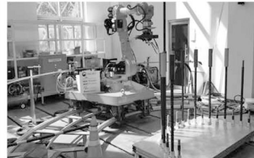
〈교각 철근 조립 자동화 Robot〉
