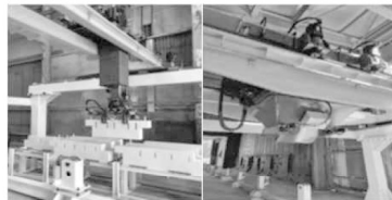
〈공장내 자동화 설비의 개발〉 * 몰드그리퍼, 분배기, 마감기, 양생챔버
