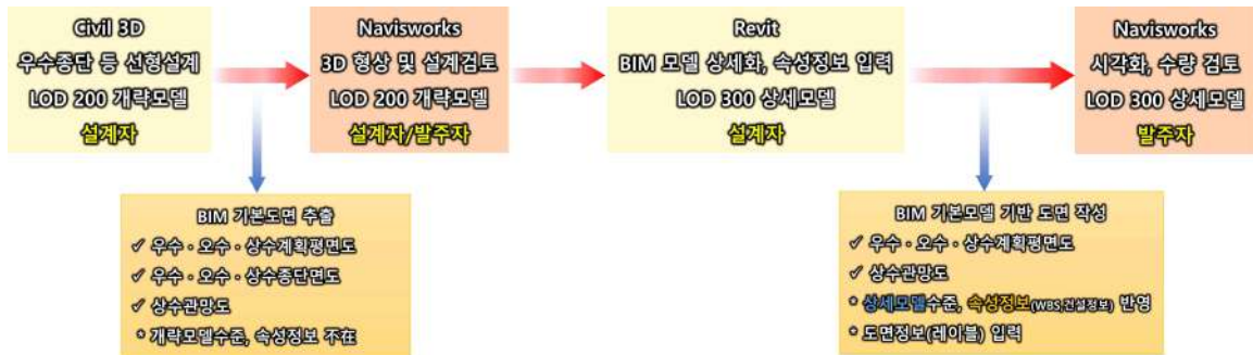
< 그림-12 > 관로시설 BIM 모델 구축 업무수행 흐름도
