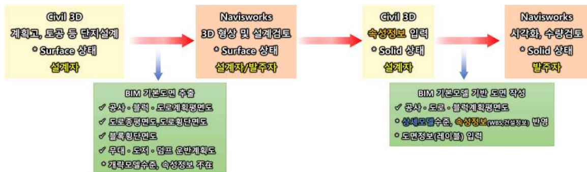
<그림-8> 토공시설 BIM 모델 구축 업무수행 흐름도
