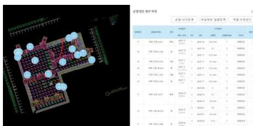
〈도면상에서 차수별 균열 기록 / 관리 / 대장 생성〉
