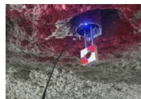
〈스마트 자동매입형 무인계측시스템 자동매입형 타겟〉
