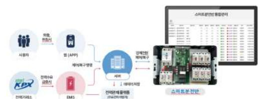
〈에너지 효율향상 및 전력수요관리용 DR 관제시스템 개념도〉
