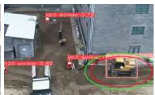
④ 중장비 작업 반경 이내 작업 근로자
