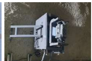
〈스마트 자동매입형 무인계측시스템 자동광파기〉
