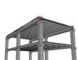
〈지하주차장(기둥, 보, 슬라브)〉
