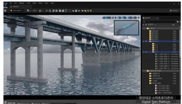
〈BIM 모델 기반의 Digital Twin 스마트유지관리 플랫폼 (청담대교)〉
