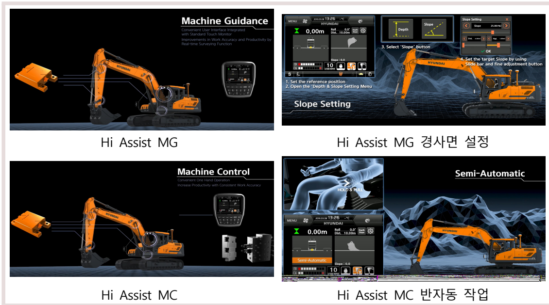
그림 11. 현대건설기계 Hi Assist MC 및 MG 구성 및 설정 화면
