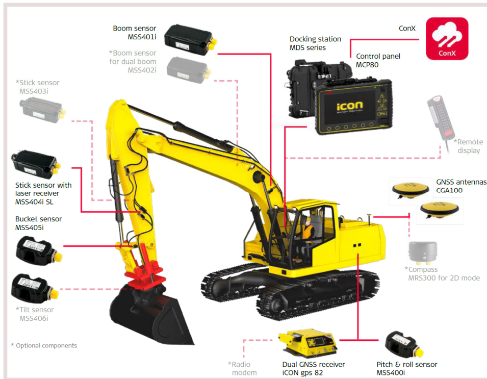
그림 4. 3D MG 굴착기 시스템 구성 예시(해외 L사 예시)
