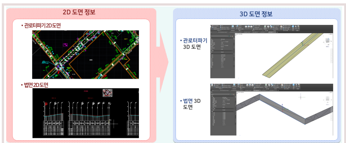
그림 20. ICT 토공 터파기 절차 중 내업(3D 도면 변환) 예시
