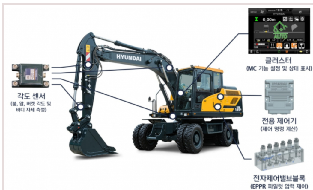
그림 6. 굴삭기 머신 컨트롤 기술 (예시)
