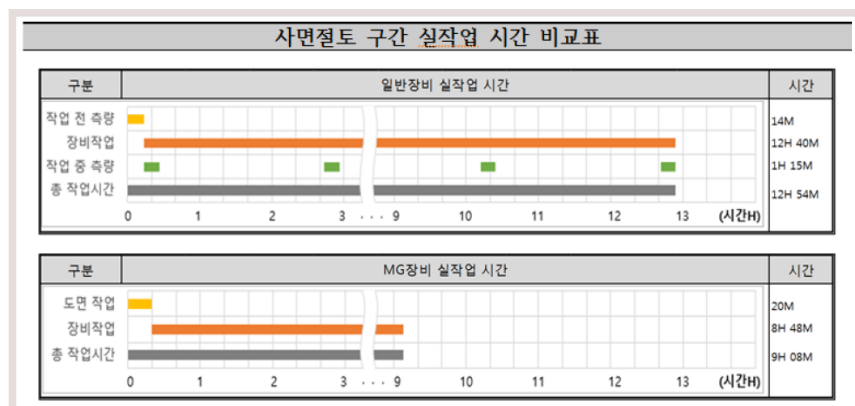
그림 41. 과천시식타운현장 MG장비 생산성 분석 예시
