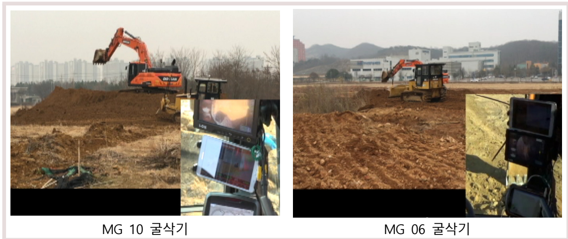
그림 55. MG 굴삭기의 작업 화면 및 적용성 평가 결과
