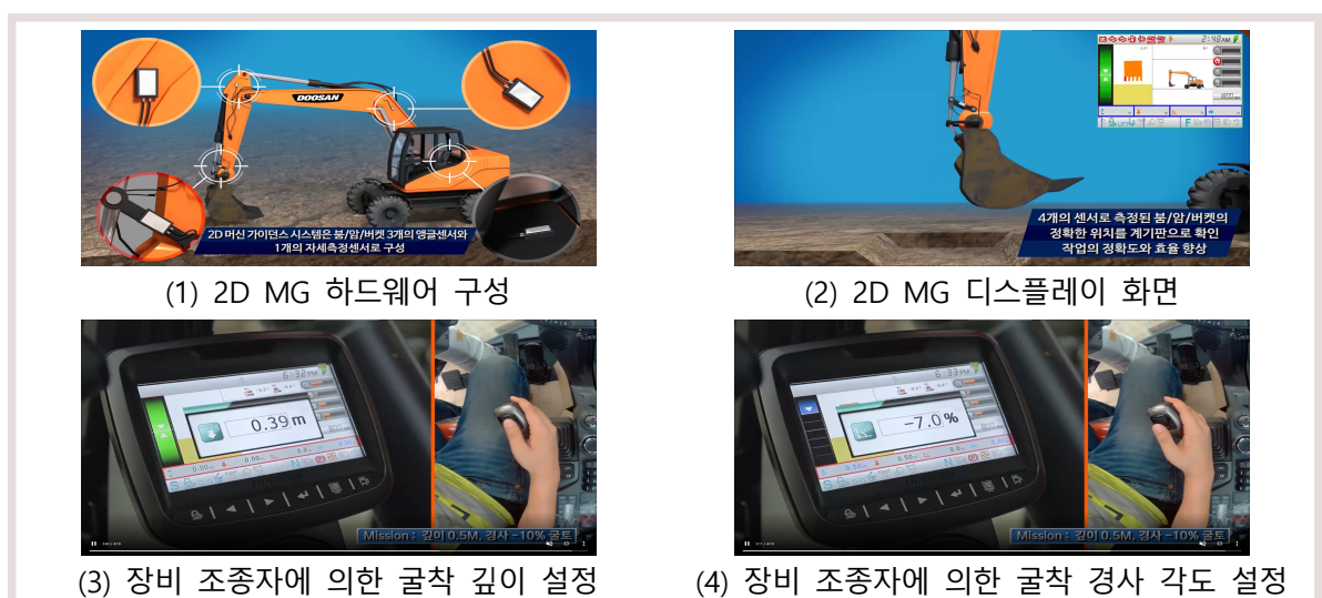
그림 3. 2D MG 굴착기의 구성, 디스플레이 화면 및 설정 기능 (HD사 예시)
